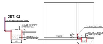
**DET. ESQUEMÁTICO DESUMIDIFICADOR SEM ESCALA**
