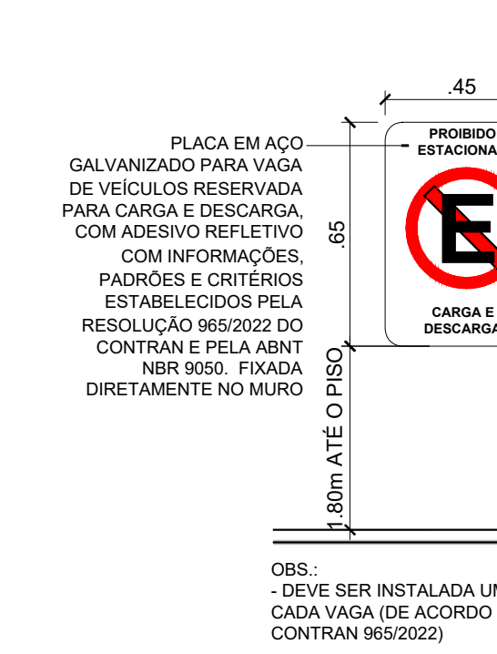
DET. PLACA CARGA E DESCARGA ESCALA 1/75
