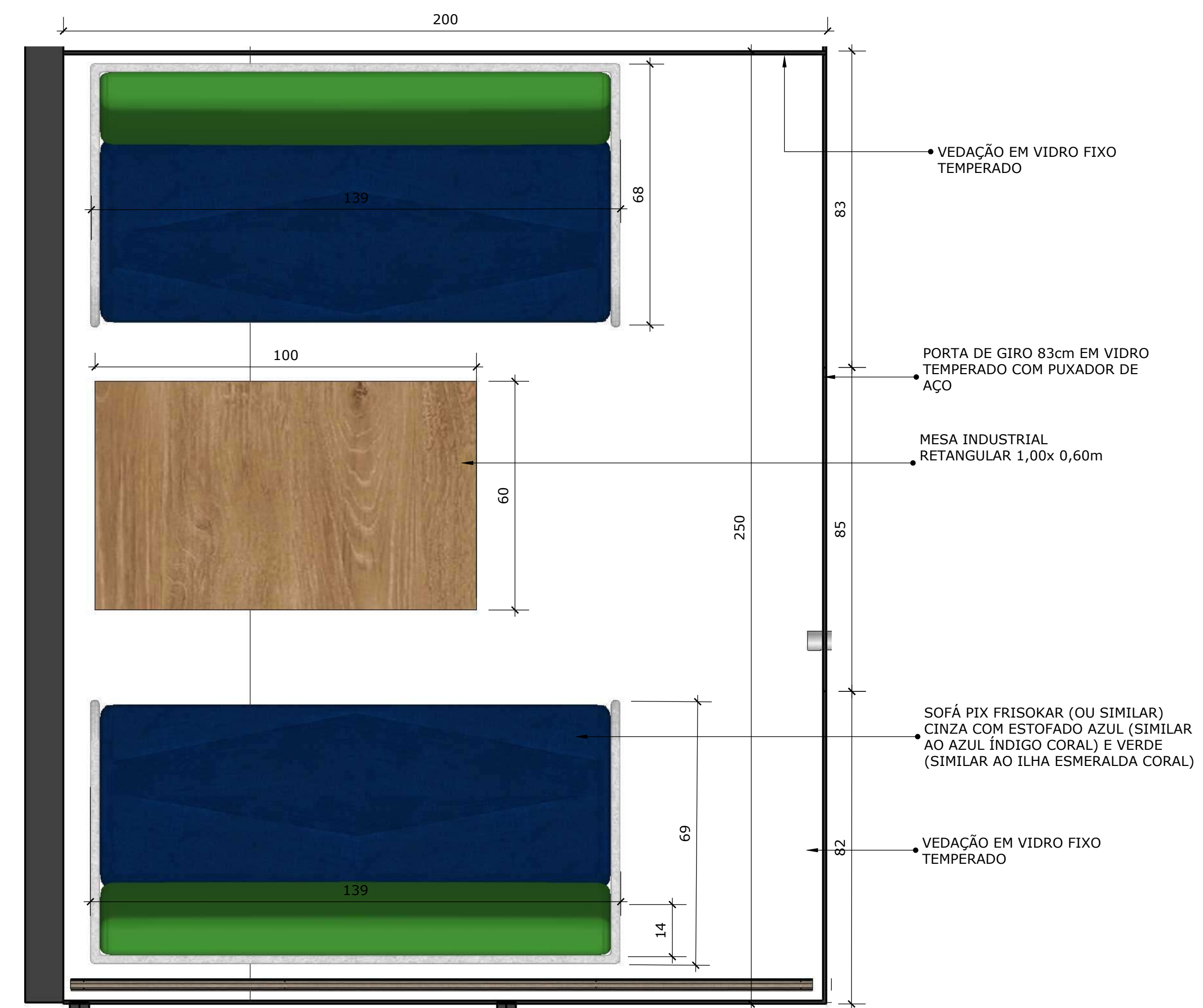
DETALHE - CABINE INDIVIDUAL ESCALA:.....1/10
