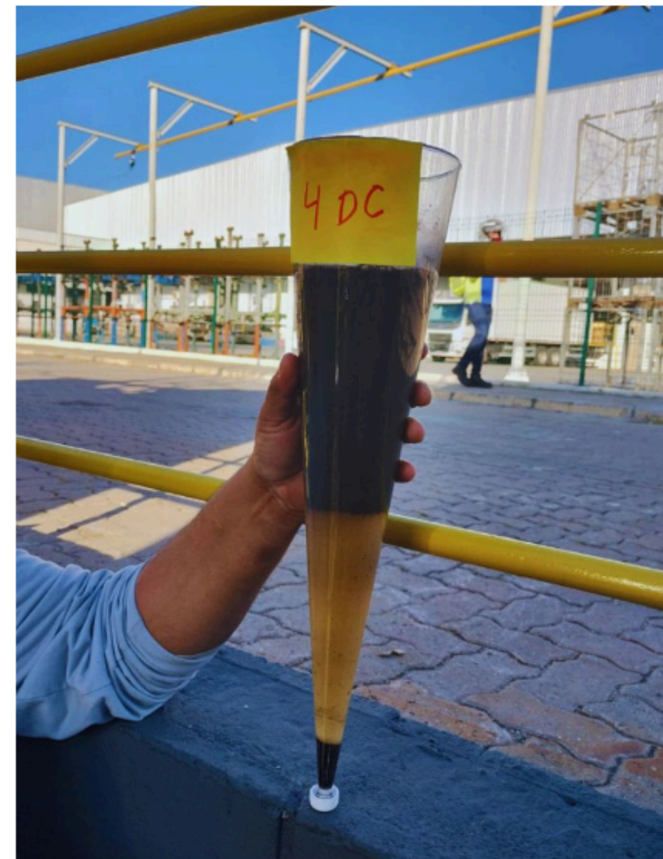
Flotação de lodo por óleos e graxas emulsionados
